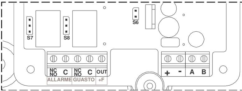
La morsetteria è costituita da due gruppi separati: quello di sinistra comprende le uscite di allarme e guasto, mentre quello di destra comprende l'ingresso alimentazione e la porta seriale.
