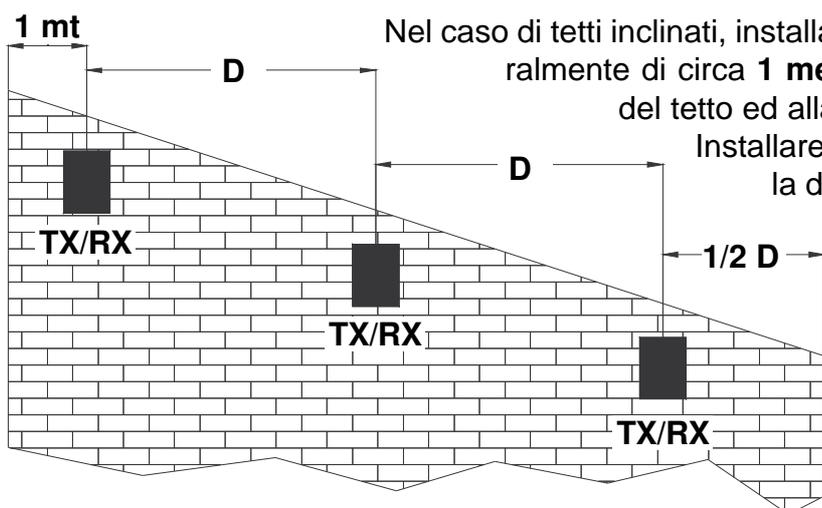
Nel caso di tetti inclinati, installare la prima barriera, discostata lateralmente di circa **1 metro** dalla parete dalla parte più alta del tetto ed alla distanza **H** dal soffitto.
