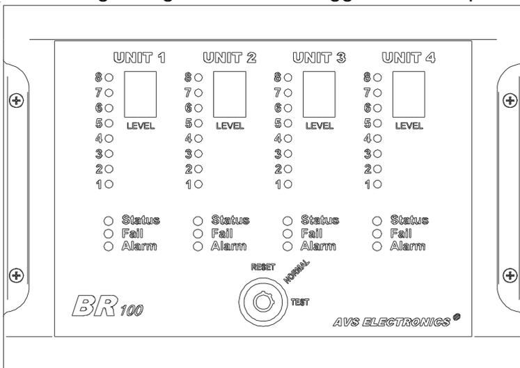
Ogni pannello remoto **BR100**, può ospitare un massimo di N°4 moduli display / led.
