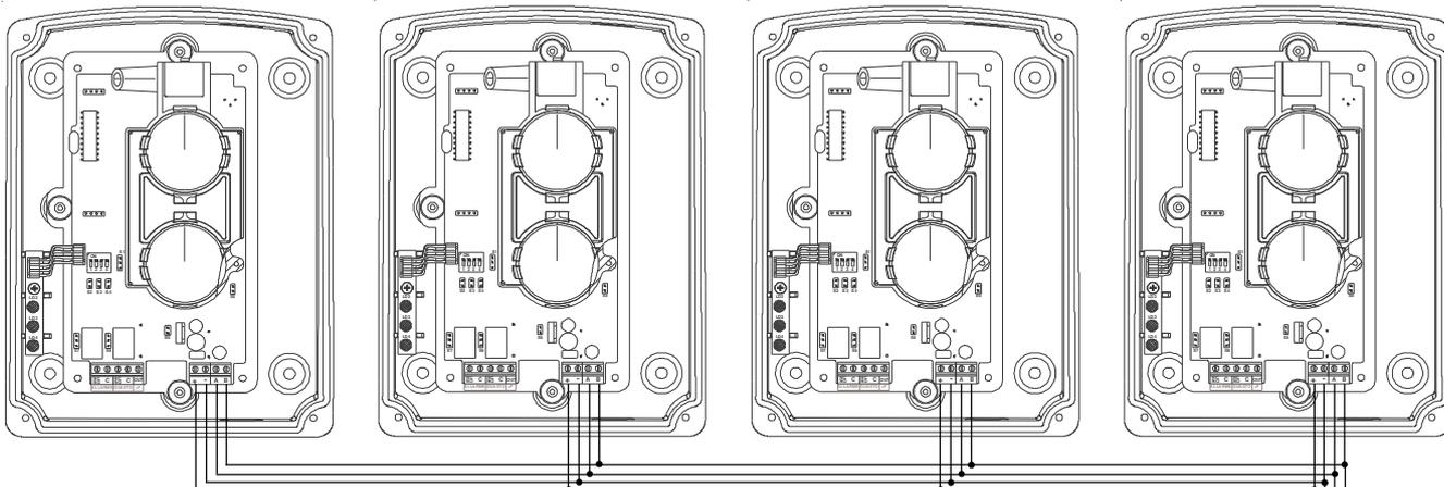
Il dialogo tra pannello remoto e barriera, avviene tramite collegamento seriale come riportato nel disegno a lato.
