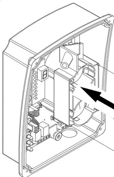
Installare il Ricevitore nel punto prefissato mantenendolo il più possibile in asse con il Trasmettitore
