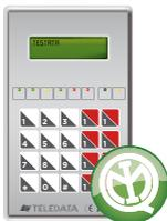
> **TKB1** Tastiera con display 16x2 righe per ARGO e SENTINEL - IMQ III° livello
