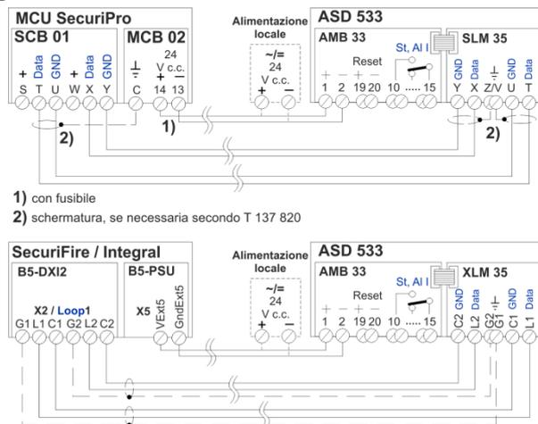
Fig. 38 Cablaggio da XLM 35/SLM 35
