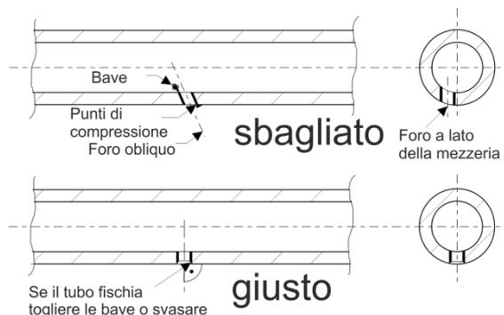
**Fig. 25 Realizzazione dei fori di aspirazione**
